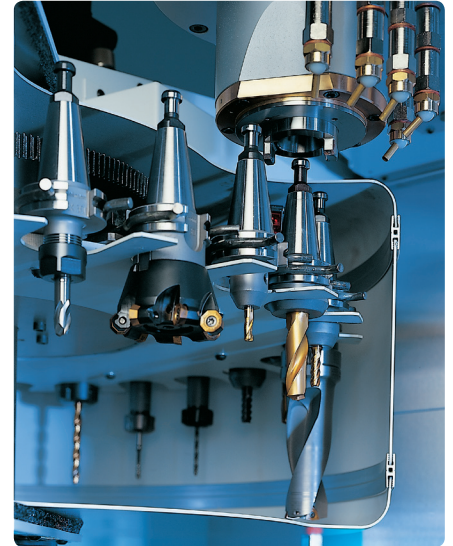
Cambio utensile con procedimento di pick-up
