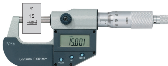
Controllo con blocchetto di riscontro
