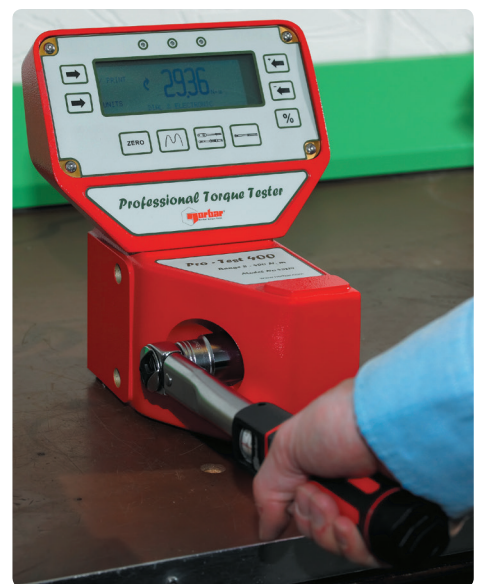
Apparecchio di prova elettronico delle chiavi dinamometriche
