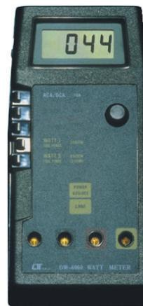
I wattmetri sono strumenti di misura che misurano contemporaneamente la corrente e la tensione e mostrano direttamente la potenza elettrica (prodotto di tensione x corrente).
